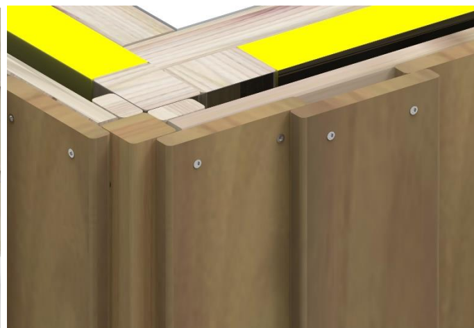
Eckausbildung mit zusätzlicher Unterkonstruktion und Rahmenholz.
