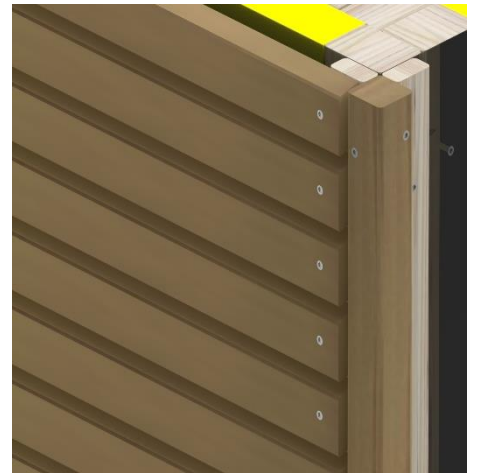
Die Enden der Profile sollten immer mit Leisten geschützt werden.
