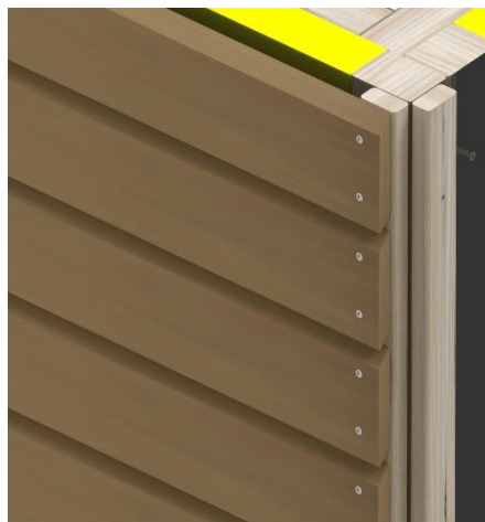
Rhombus-Profil \geq 80 mit 2 Schrauben oder Nägeln befestigen.
